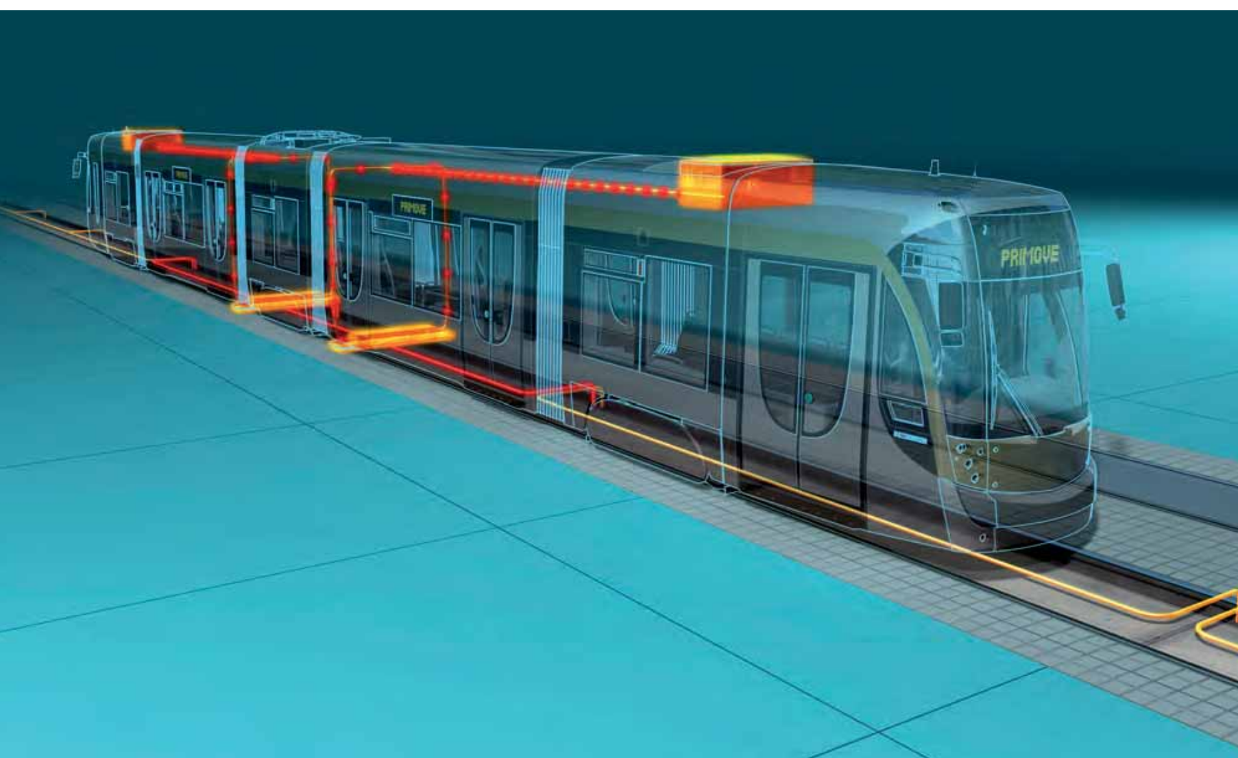
Primove, fahrdradtlose Stadtbahn
